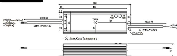
1. 電源別置形のため、既存の安定器を取り外し後接続してください。
