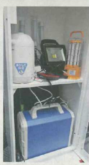
防災用蓄電池ボックスと内容物
